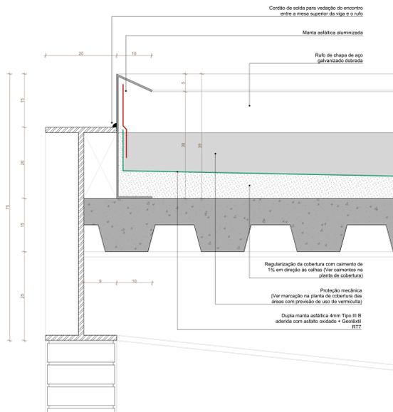
C01 DETALHE VIGA DE BORDA FACHADA
